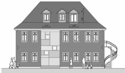
Fassadendämmung und einer Neuverfüllung der dicken Wand an der Gera. Mit dieser Dämmwand endet hoffentlich das Wasserproblem im Keller.
